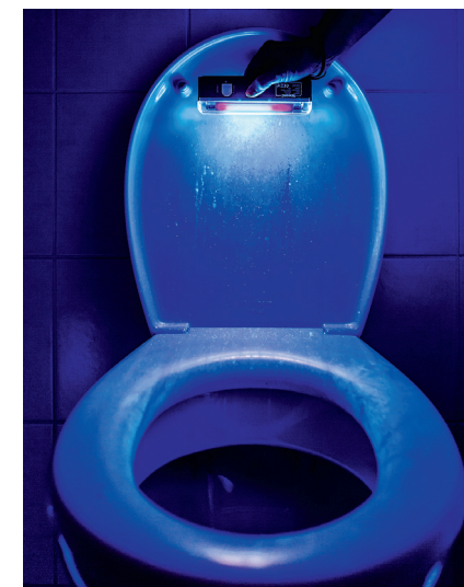
NÄHTAMATU NÄHTAVAKS: Sinise valgusega UV-lamp toob tualettruumis nähtavale kõikvõimalikud pritsmed, nired ja mustuse, mida palja silmaga ei näe.
